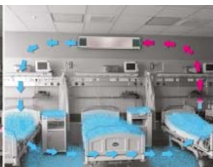
Proces oczyszczania powietrza promiennikami wewnętrznymi (powietrze)
